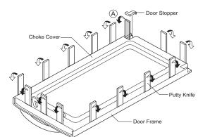
Figure C-3. Door Disassembly
